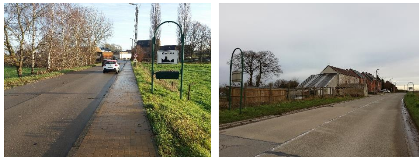
Photos 61 & 62 : Absence d'effet de porte aux entrées de Marbais et de Sart-Dames-Avelines sur la rue du Petit Mont (g.) et sur la route de Frasnes (dr.)
